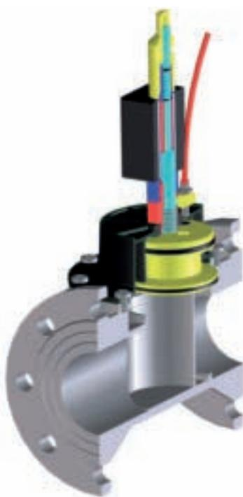
La electroválvula de seguridad para gas con rearme manual con sensor magnético es una electroválvula tradicional que puede equiparse con un dispositivo de lectura del cierre efectivo del obturador en el asiento de estanqueidad, separado del sistema de cierre mediante la bobina electromagnética. Dicho dispositivo de seguridad es de tipo magnético inductivo normalmente cerrado (dispositivo de fin de carrera).
