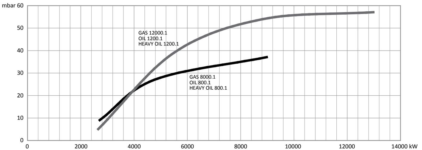
**HEAD LOSS OF THE BURNER | ПОТЕРЯ ДАВЛЕНИЯ В ОГНЕВОЙ ГОЛОВКЕ ГОРЕЛКИ
