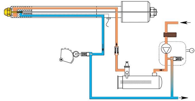
HEAVY OIL PREPARATION RING | НАГРЕВАТЕЛЬНЫЙ КОНТУР ПОДГОТОВКИ ТОПЛИВА
